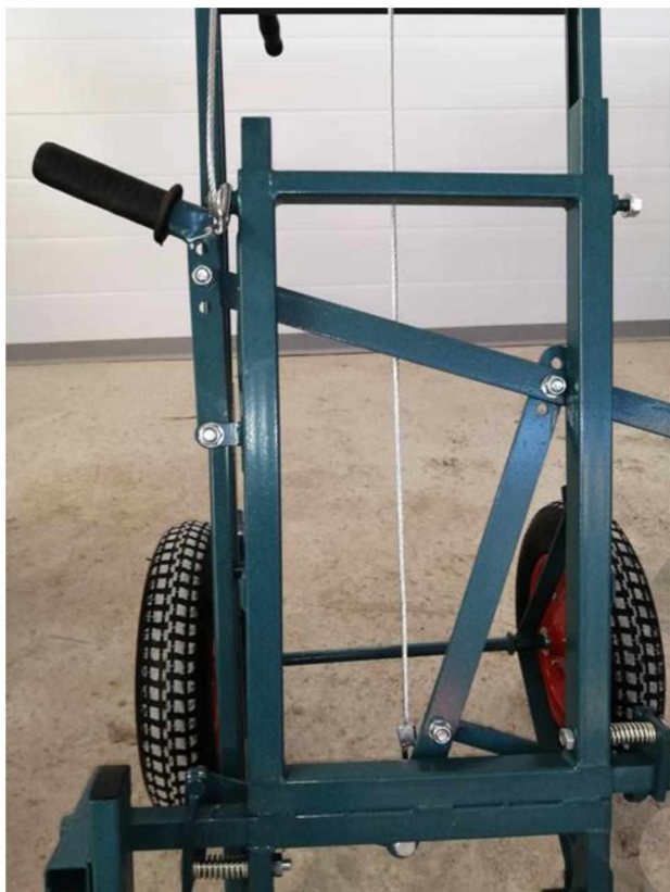
рукоятка фиксатора в верхнем положении захваты не зажаты
